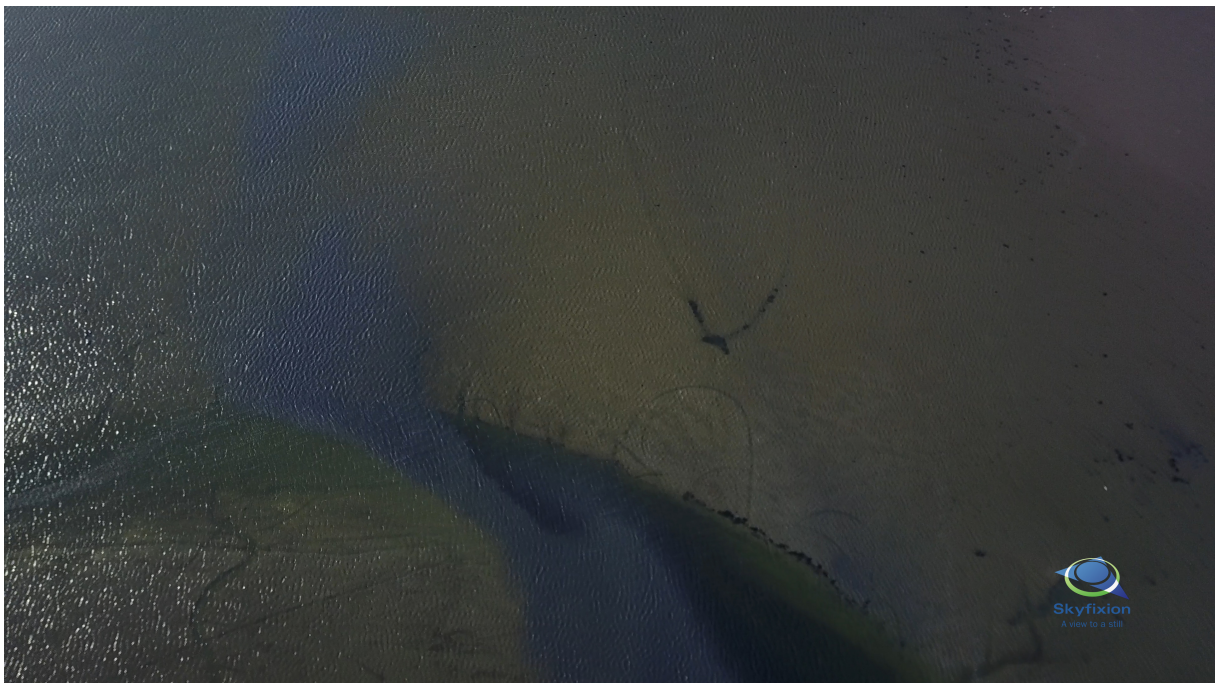
Afbeelding 4. Luchtopname van het opgewerfelde slib uit de jachthaven dat haaks over de geul over de platen wegstroomt (maart 2017, © Skyfixion).
